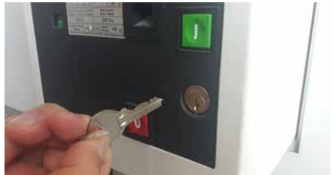
4. ВСТАВЬТЕ КЛЮЧ, ВЫНУТЫЙ ИЗ МЕХАНИЗМА РЕЗАКА, В ЗАМОК МЕХАНИЗМА РАЗЪЕДИНИТЕЛЯ И ПОВЕРНИТЕ ЕГО ПРОТИВ ЧАСОВОЙ СТРЕЛКИ, ЧТОБЫ РАЗБЛОКИРОВАТЬ.
