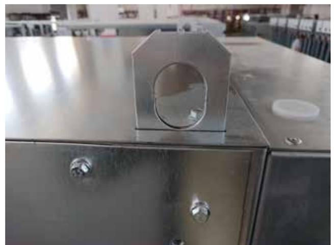
Hücreleri; tesisin tek hat şemasına uygun olarak aşağıdaki fotoğrafta gösterilen kare şeklindeki delikleri (1) M8x20 civata kullanarak teker teker yana birleştiriniz.
