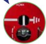
3. Вставьте рычаг управления в открывающийся паз выключателя нагрузки и ЗАГРУЗИТЕ пружину, повернув ее против часовой стрелки. Выньте рычаг открывания из прорези для открывания.
